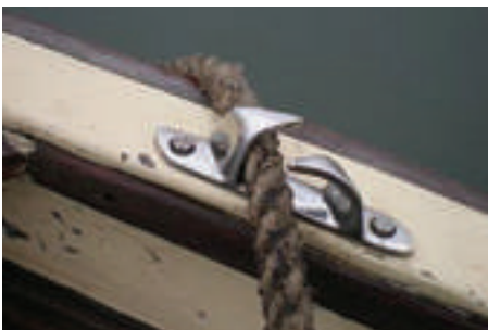
Σχ. 1.4η Τονοδηγός ή όκιο. Αλλάζει την κατεύθυνση του σχοινιού ή το κρατάει σε μία κατεύθυνση.
